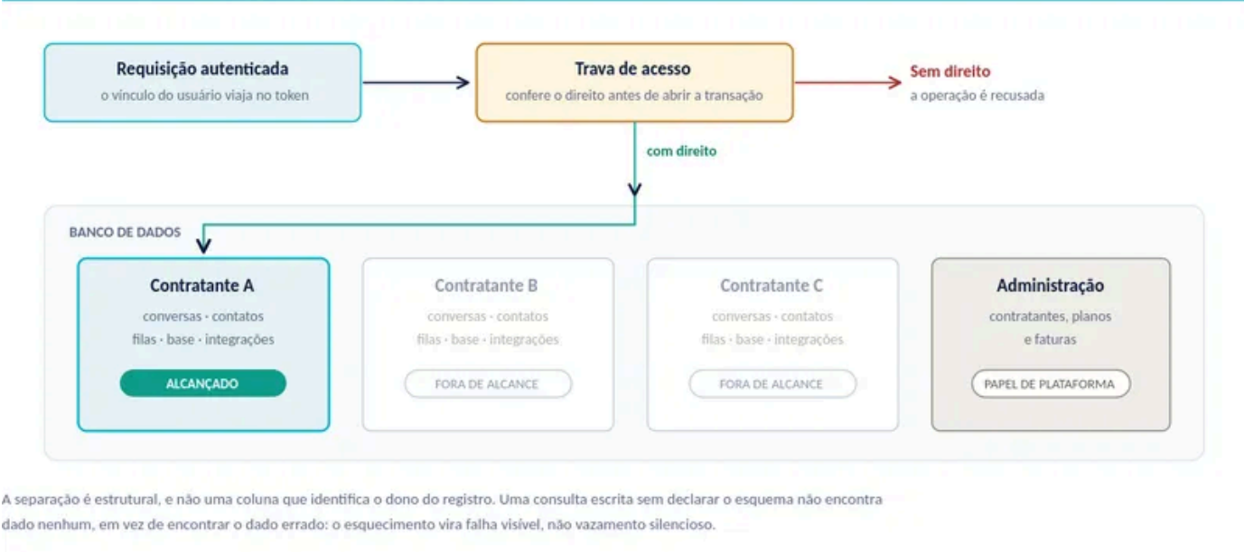
Figura 3 · Isolamento entre contratantes: a trava decide qual esquema a requisição alcança
